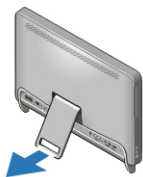
Figura 3. Installazione del sostegno posteriore
